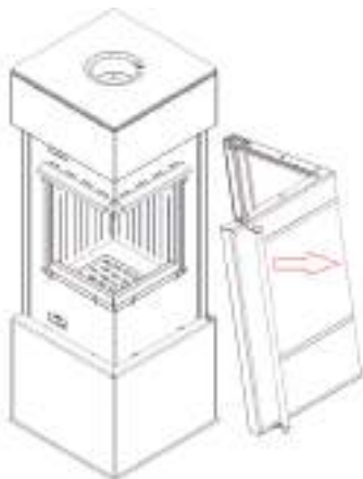
21. Kolejność demontażu oraz wymiany deflektora i wyłożenia accumote – THOR The procedure for the baffle and Acumotte lining disassembly and replacement – THOR
